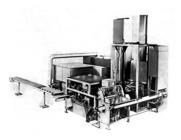
Abbildung 1 Hülsenreinigungsanlage mit Prüf- und Abpackvorrichtung für Streckzwirnhülsen
