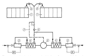
Thermische Abluftreinigung mit Abluftvorwärmung, Abluftregelbereich 1:4 – 1 Trockner, 2 Reinluftkamin, 3 Combustor, 4 Abluftvorwärmer, 5 Abluftventilator, 6 Abluftventilator, 7 Bypass-Leitung.
