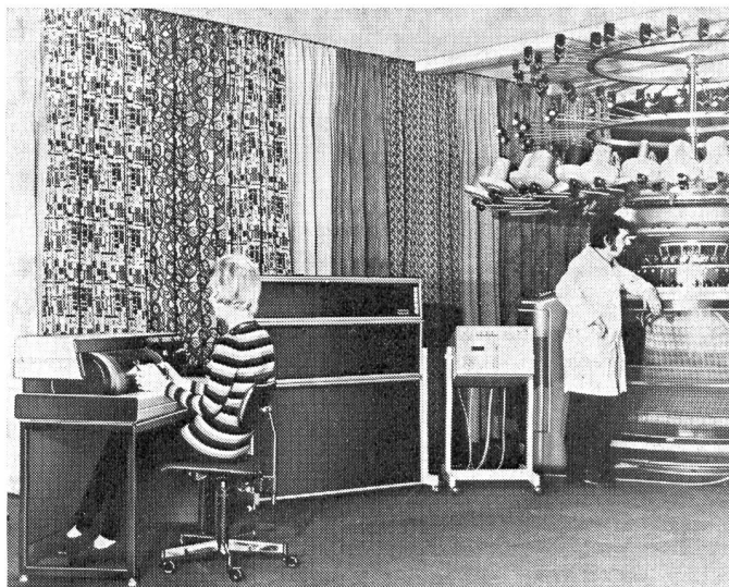
Patronik 200 — Von links nach rechts: Musterfassungseinheit MEL 200, Lochbandleser LBL 200, Strickrechner SRL 200, Rundstrickmaschine Moratronik MK 2.
