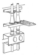
Abbildung 11 Positionierung des Ringläufers
