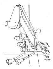
Abbildung 17 Einlegen des Fadenendes
