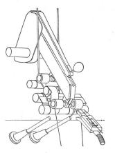
Abbildung 16 Anlegen des Fadenendes
