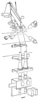
Abbildung 5 Fotoelektrische Fadenüberwachung mit Spinnstellenregistrierung
