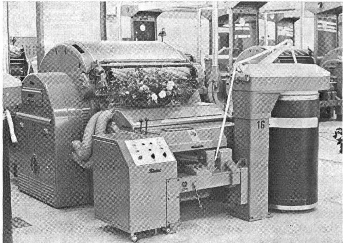
fassen die Abgänge an der Quelle und transportieren sie pneumatisch in den zentralen Sammelraum bzw. zu den Filtern. Unbeliebte und körperlich schwere Arbeiten — wie z. B. der Wickeltransport und das Beseitigen der Abfälle an den Maschinen oder im Staub-Keller — gehören der Vergangenheit an. Die früher übliche Wickelvorlage ist durch die wickellose, kontinuierliche Kardenspeisung System «Aerofeed®» ersetzt worden.
