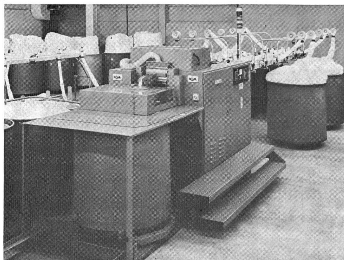
Abbildung 2 Zahnscheibenstrecke ZSR 20, Gesamtansicht
