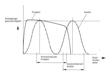
Abbildung 3 Verlauf der Eintragungsgeschwindigkeit bei Projektil- und Greiferwebmaschinen
