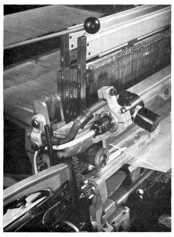
Abbildung 2 Anbau eines LF-4-Tastkopfes an einer Schützenwebmaschine
