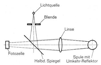
Abbildung 1 Strahlengang im optischen Tastkopf des Schussfühlers LF-4
