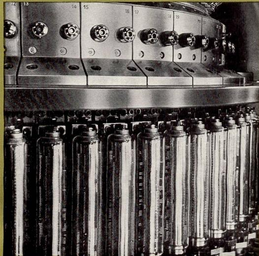
Bild: Hochinteressant ist diese neue Jacquardmaschine OVJA 64. 64 Systeme, 18 U/min., Maschinenfeinheit bis E 30, steigungsfreies Muster, Rapportgröße 3farbig 144/72 x 240. Dies ist nur ein Beispiel aus dem großen Mayer-Programm mit nahezu 50 Grundtypen.
