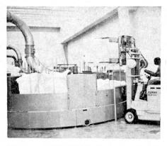
Abbildung 6 Verwirklichte automatische Ballenöffnung Rieter «Carousel», 1970
