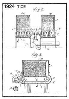
Abbildung 5 Patent für automatische Ballenöffnung, 1924
