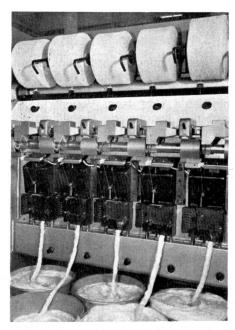
Abbildung 4 Offen-End Spinnmaschine, 1972
