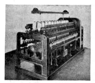
Abbildung 2 Ringspinnmaschine, 1877
