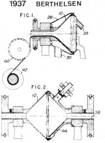
Abbildung 10 Patent für Offen-End-Rotor-Spinnen, 1937
