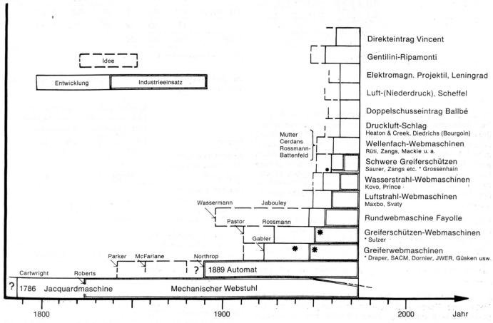
Abbildung 7 Zeittafel der Webmaschinen-Entwicklung
