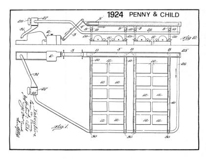
Abbildung 7 Vorschlag von Penny und Child für eine automatische Kardenspeisung, 1924
