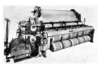
Sulzer-Frottierwebmaschine Typ G mit einer Nennbreite von 110" (279 cm), belegt mit abgepassten Handtüchern in fünf Bahnen
