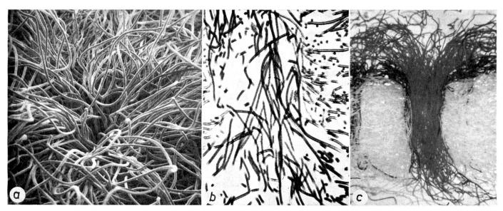
Abbildung 7 Darstellung der Einstichstelle an Nadelfilz nach veschiedenen mikroskopischen Methoden — a) Rasterelektronenmikroskopische Aufnahme bei einer Vergrösserung von 20:1; b) Mikrotomschnitt in der Einstichzone, es werden nur Fragmente der verhältnismässig wirr liegenden Fasern dargestellt; c) Dünnschliff, ca. 1 mm stark, die Aufnahmeschärfe liegt auf der Anschliffebene.
