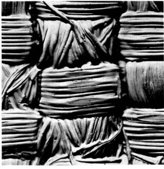
Gewebe aus Polyamid-Stapelfasern, dessen Oberfläche in Gelatine abgedrückt wurde (100:1). — Bindeköpfe aus dem Streifen, der durch die Markierung des Meterzählwerkes entstand. Auch hier ist die Schädigung durch die Deformation der Fasern zu erkennen,
