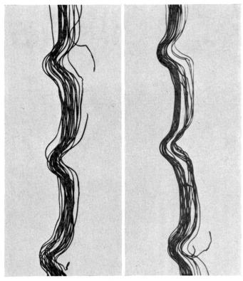
Abbildung 2 Garne, den Streifen entnommen. – Die Schädigung des Garns rührt von der Ueberdehnung des Kettfadens her. Man kann sich die Deformation so erklären, dass die stärker gespannten Fäden ein anderes Schrumpfverhalten zeigen als ein normaler Faden. Bei einer nachfolgenden Nass- und Trockenbehandlung, bei der diese Kettspannungsunterschiede durch mechanische Einwirkungen auszugleichen versucht werden, tritt dann die im Lupenbild gezeigte Schädigung ein
