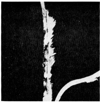
Polyesterfaser, abgebildet zwischen gekreuzten Polarisationsfiltern, einem Kettspritzer entnommen (200:1)
