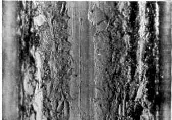
Abbildung 4 Untersuchung der Nadellauffläche im Nadelzylinder der Strickmaschine – Fotografisch umgekehrter Querschnitt durch die in die Nuten eingegossene Silikonkautschukmasse (oben). Replica aus Uhu hart<sup>®</sup> des Gleitnutengrundes einer anderen Stelle. Die Beobachtungen sind identisch mit der Darstellung des Querschnittes, in der Mitte die erhöhte Auflagefläche, seitlich starkte Gratbildung (unten).
