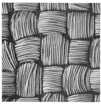
Streifiger Ausfall eines PA-Gewebes. – Gegenübergestellt sind ein egaler Abschnitt (links) und ein streifiger Abschnitt (rechts). Die unterschiedliche Einarbeitung der Kettfäden tritt beim Vergleich augenfällig in Erscheinung (Abdruck 50:1).
