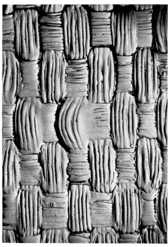
Abbildungen 3 und 4 Abdruck von 2 Falten in einem Gewebe aus PA-Endlosfäden (70:1). — Normalerweise haben Kettspannungsunterschiede Kettbanden oder Kettstreifen zur Folge. Je nach der Einstellung des Gewebes und dem Ausmass dieser Differenzen können aber auch Falten entstehen. In einer Falte finden nämlich die Spannungsunterschiede einen Ausgleich. Die Mikrofotografien zeigen, wie in den Falten einige Garne etwas weniger gespannt sind als ihre Nachbarfäden.
