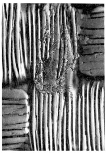
Polyamid-Futterstoff mit durch das Webschiffchen geschädigten Kettfäden (150:1)
