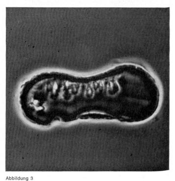
Abbildungen 2 und 3 Querschnitte geschädigter PAC-Fasern
