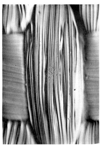
Abdrücke von Bindeköpfen eines Gewebes aus Sekundärazetat. Die Schädigung ist an der leichten Abplattung der Fasern zu erkennen (200:1).
