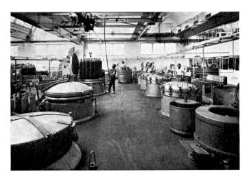
«Helanca®»-Garnfärberei mit automatisch gesteuerten Färbeapparaten
