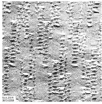
Abbildung 5 Strukturgewebe aus Glasseide in Kette und Schuss
