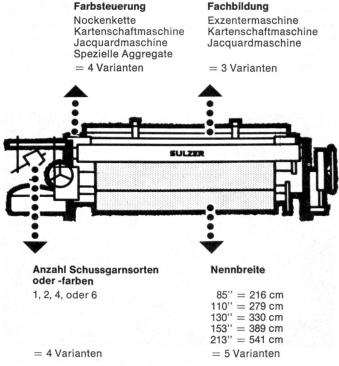
Abbildung 1 Aufbau und Möglichkeiten der Maschine
