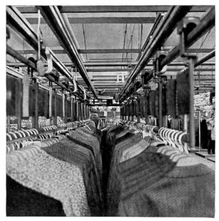
psb-HF-Lager im gefüllten Zustand, drucklos gestaute Wagen
