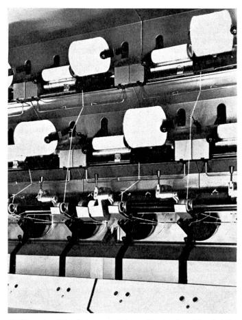
Abbildung 1 Nahaufnahme von Spinnpositionen einer Offen-End-Maschine (BFF).
