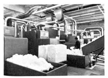
Erfassen der staub- und faserhaltigen Maschinenabluft einer Putzerei und fördern über Rohrleitungen zu den verschiedenen Komponenten der Luwa<sup>®</sup> Faserdeponie-Anlage.
