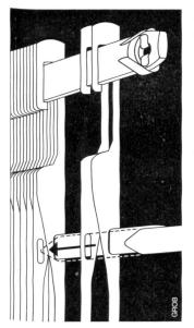
Abbildung 5 Einschieben von Sortierschienen in die Sortierschlitze bei den SOLOMIX wie auch bei den INTERMIX Webelitzen.
