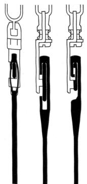
Abbildung 2 Geschlossene O-förmige Endösen der herkömmlichen Flachstahl-Webelitzen, seitlich offene C-förmige Endösen GROBAMTEX und J-förmige Endösen GROBEXTRA Flachstahl-Webelitzen.
