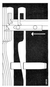
Nach erfolgter Trennung werden die TRANSEXTRA Transportschienen wiederum in die Endösen der nunmehr voneinander getrennten SOLOMIX und INTERMIX Webelitzen eingeführt und die Sortierschienen entfernt.
