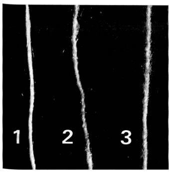
1. Rohgarn, 2. Dampfbehandeltes Garn, 3. Heissluftbehandeltes Garn
