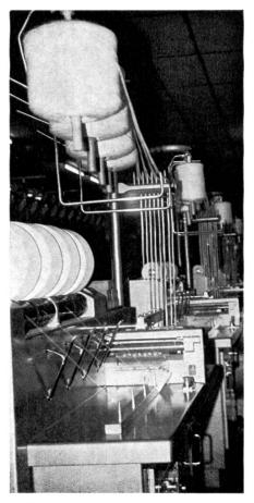
Abbildung 6 Self-Twist-Spinnanlage in einem Industriebetrieb (Tuchfabrik)
