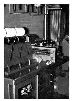
Abbildung 3 Spinnzone und Garnaufwindungsbereich
