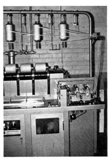
Abbildung 1 Frontansicht eines Self-Twist-Spinnaggregates
