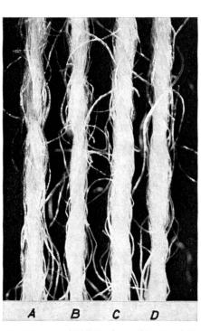
Abbildung 9 Self-Twist-Garn (ST- und STT-Garn)
