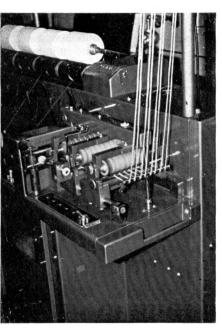
Abbildung 2 Hochverzug-Streckwerk mit Vorgarn-Einlauf
