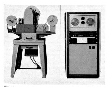
Gesamtansicht der Stanzanlage P3 mit Steuerschrank und Stanzeinheit zur Herstellung der Monofilme
