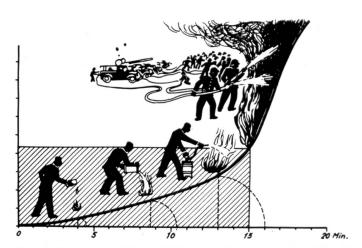
Wird ein Brandausbruch innert 5 Minuten entdeckt, so genügt vielleicht ein Glas Wasser zu seiner Löschung. Je länger man zuwartet, umso mehr Wasser wird benötigt, bis selbst die Feuerwehr machtlos ist (Bild BVD).
