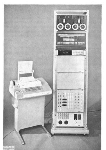
Datenerfassungsanlage (mit Elementen des Daten-Input/Output-Systems Sulzer DI/OS) zur Auswertung und Steuerung oft wechselnder Versuche im Laboratorium für physikalische Chemie einer Schweizer Hochschule,
