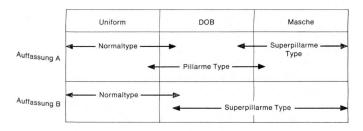
Die Pillarmut von Polyesterfasern wird durch eine Reduzierung in der Querfestigkeit erreicht. Während die Querfestigkeit der superpillarmen Type nur 10 % der Normaltype beträgt, sinkt die Längsfestigkeit weit weniger (Abbildung 1).
