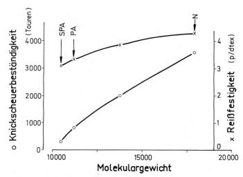
Knickscheuerbeständigkeit und Reissfestigkeit von Poly-Abbildung 1 esterfasern in Abhängigkeit vom Molekulargewicht [1]. N = Normaltype, PA = pillarme Type, SPA = superpillarme Type.
