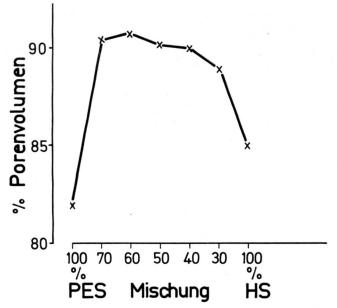
Abbildung 2 Porenvolumen in Abhängigkeit vom Anteil an Schrumpffasern [2].
