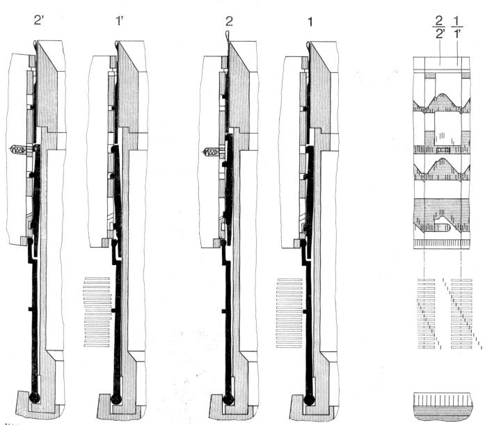
Abbildung 2 Das Zusammenwirken von Schwenkplatinen und Steuerkipp-Platinen bei der Nadelauswahl
