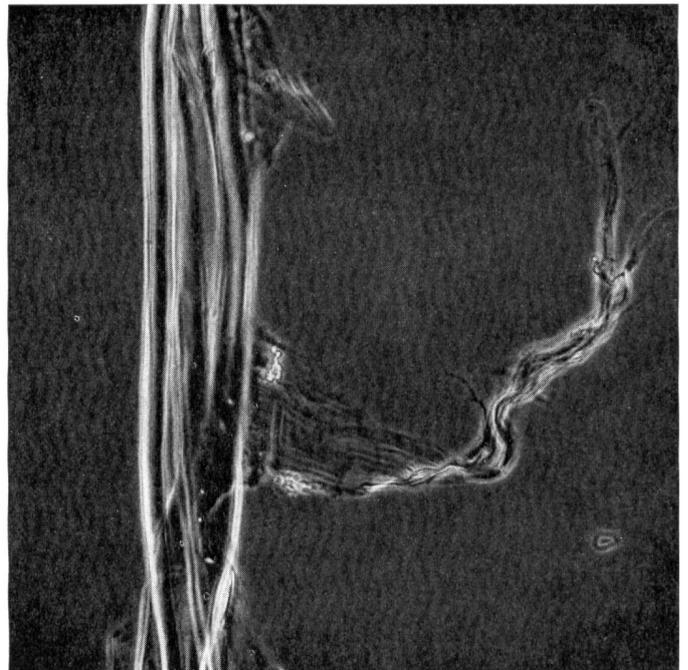
Polyacrylnitrilfaser mit einer für die mechanische Schädigung typischen Verletzung (Phako 250:1)
