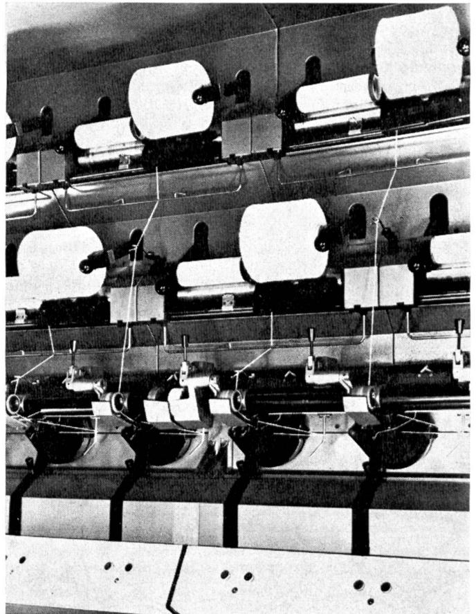
Abbildung 1 Nahaufnahme von Spinnpositionen einer Offen-End-Maschine (BFF).
