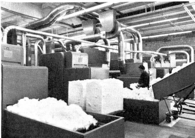
Erfassen der staub- und faserhaltigen Maschinenabluft einer Putzerei und fördern über Rohrleitungen zu den verschiedenen Komponenten der Luwa® Faserdeponie-Anlage.
