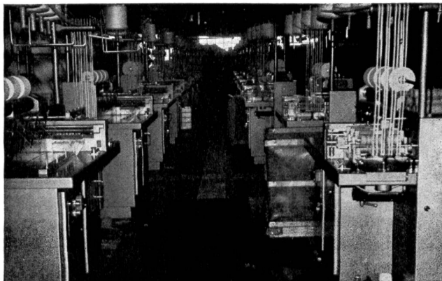
Abbildung 12 Grössere Self-Twist-Spinnanlage in einer Kammgarnspinnerei
