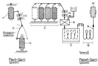
Abbildung 6 Schematische Darstellung der zwei prinzipiellen PAVENA-Herstellungsprozesse (PAVIL und PASET)
