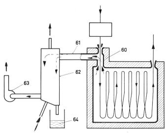
Abbildung 15 Geschlossenes Dampfsystem (schematisch)
