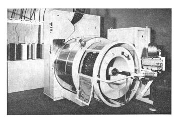
Abbildung 8 Gesamtansicht der «Tamaro II» zur Herstellung geklebter Garne (PASET)
