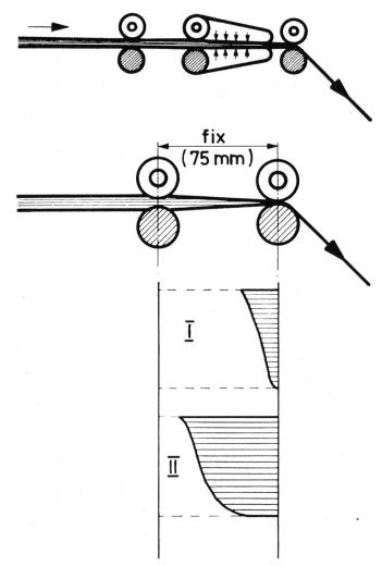
Abbildung 5 Prinzipvergleich zwischen der konventionellen Verzugstechnik (oben) und der PAVENA-Verzugstechnik unter Klebebedingung (unten)
