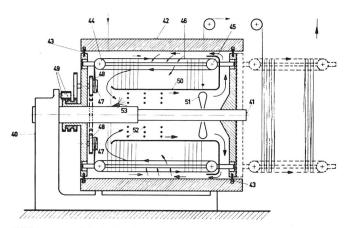
Abbildung 13 Schnitt durch das Trocknungs- bzw. Fixieraggregat
