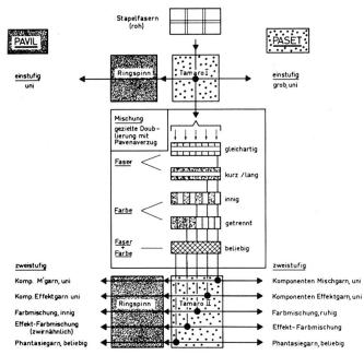
Abbildung 10 Grundlegende Möglichkeiten der PAVENA-Technik
