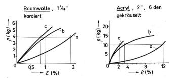
Abbildung 14 Kraft-Dehnungsdiagramme von Colorbändern
