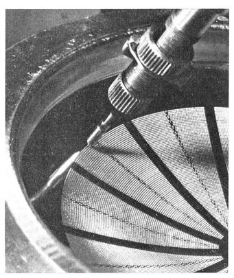
Die Herstellung einer Spinndüse mit gewölbtem Boden: Bei Bohrungen bis 50  $\mu$ m (Toleranz  $\pm$  1  $\mu$ m) und der gleichzeitig erforderlichen hohen Oberflächengüte ein feinmechanisches Meisterstück, das langjährige Erfahrung voraussetzt.
