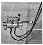
Das Fadeneinlaufmessgerät Typ 8000, das in engem Kontakt mit einer schweizerischen Wirkereiunternehmung entwickelt wurde, genügt sämtlichen Anforderungen in Bezug auf Messgenauigkeit, rationellen Einsatz und Preis. Das Gerät besteht aus einem Reihenzähler, ein oder mehreren Fadenlängenmessern und einem Stofflängenmesser und misst gleichzeitig sowohl die Fadeneinlauflängen mehrerer Bäume, wie auch die produzierte Stofflänge pro bestimmte Anzahl Maschenreihen.
