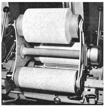
Abbildung 3 Wickeleinheit der TZ 21
