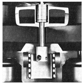
Abbildung 1 Heberlein Falschzwirn-Magnetspindel mit eingebauter Einzel-Drehzahlmessonde
