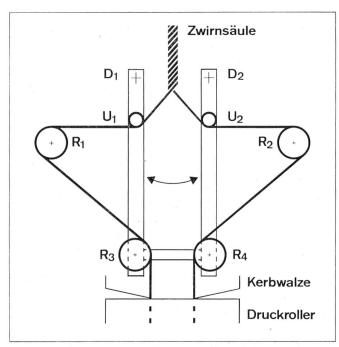
Abbildung 4 Schema Trennaggregat mit Lieferwerk
