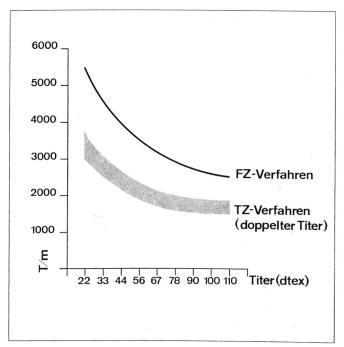
Abbildung 2 Gegenüberstellung der Garndrehungen im Falschzwirnund Trennzwirnverfahren
