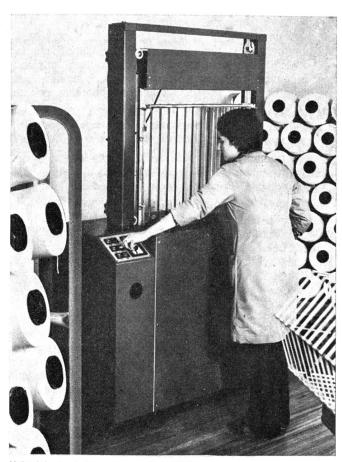
Heberlein Kontraktionsmessgerät WKK 3
