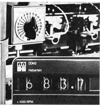
Abbildung 2 Heberlein Einzel-Drehzahlmessonden angeschlossen über einen Wahlschalter am Digital-Drehzahlmessgerät DDM 2
