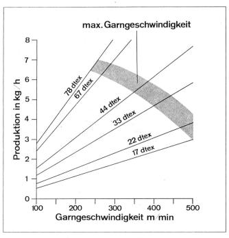
Abbildung 5 Kräuselgarnproduktion einer TZ 21 mit 32 Trennaggregaten und 90 % Nutzeffekt
