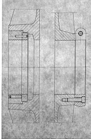
Gewindekettbäume mit tangential verrippten Scheiben für alle Belastungsarten, In- und Ausland-Patente. Höchste Belastbarkeit bei kleinster Deformation.
