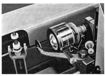
Speichervorrichtung der Einfarben-Maschine
