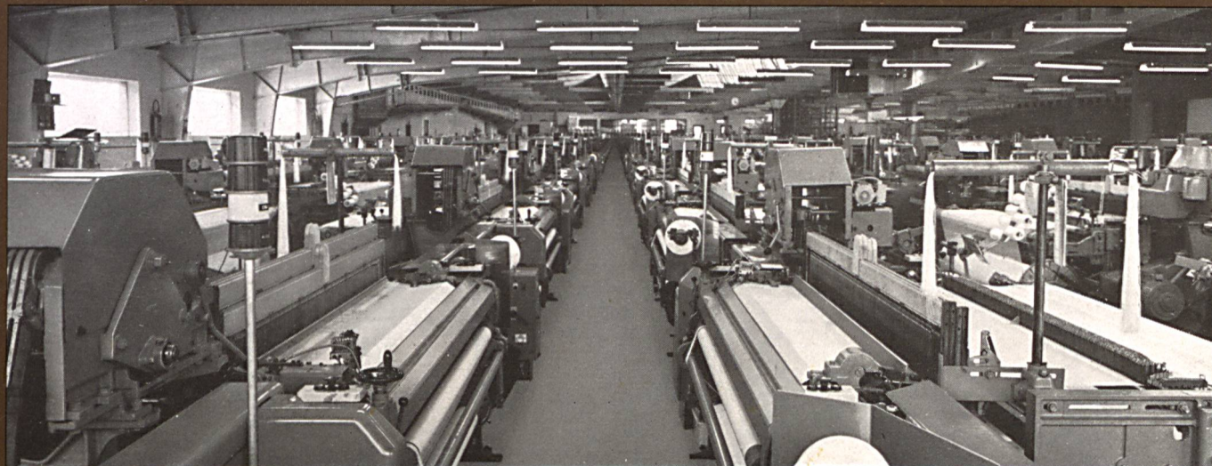
Weberei mit schützenlosen Einfarben-Webmaschinen Typ VERSAMAT
