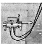
Das Fadeneinlaufmessgerät Typ 8000, das in engem Kontakt mit einer schweizerischen Wirkereiunternehmung entwickelt wurde, genügt sämtlichen Anforderungen in Bezug auf Messgenauigkeit, rationellen Einsatz und Preis. Das Gerät besteht aus einem Reihenzähler, ein oder mehreren Fadenlängenmessern und einem Stofflängenmesser und misst gleichzeitig sowohl die Fadeneinlauflängen mehrerer Bäume, wie auch die produzierte Stofflänge pro bestimmte Anzahl Maschenreihen.
