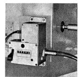
Das Fadeneinlaufmessgerät Typ 8000, das in engem Kontakt mit einer schweizerischen Wirkereiunternehmung entwickelt wurde, genügt sämtlichen Anforderungen in Bezug auf Messgenauigkeit, rationellen Einsatz und Preis. Das Gerät besteht aus einem Reihenzähler, ein oder mehreren Fadenlängenmessern und einem Stofflängenmesser und misst gleichzeitig sowohl die Fadeneinlauflängen mehrerer Bäume, wie auch die produzierte Stofflänge pro bestimmte Anzahl Maschenreihen.
