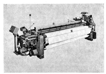
Einschützige Automaten-Webmaschine SAURER 300 versa-speed
