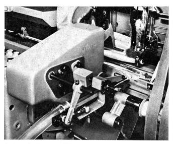
Spulenwechsel-Automat mit Klemmschere
