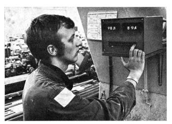
Abbildung 3 Fernanzeige-Einheit im Websaal. Rechte Anzeige: Nutzeffekt aller angeschlossenen Maschinen. Linke Anzeige: Abzufragender Nutzeffekt von Einzelmaschinen oder Maschinengruppen.
