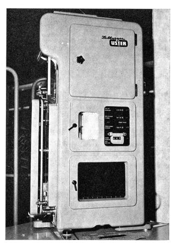
Festigkeitsprüfgerät Uster «Dynamometer»
