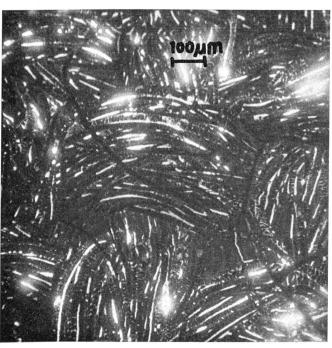
Abb. 14 Wollgewebe mit Filzfreiausrüstung (Kathodolumineszenz-Bild)
