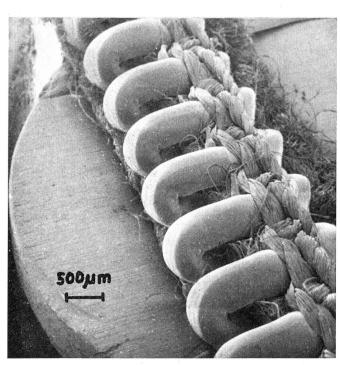
Abbildung 9 Reissverschluss-Noppenreihe mit Einbindung
