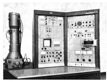
Abbildung 1 Raster-Elektronenmikroskop «Stereoscan»
