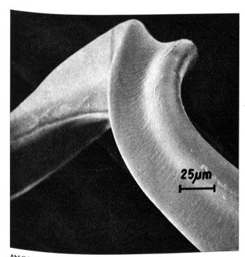
Abbildung 4 Polyamid-6-Profilfaser
