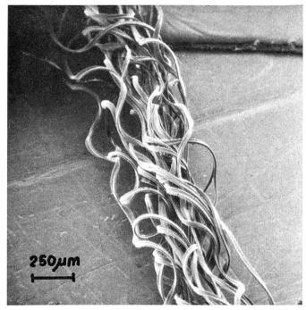
Abbildung 8 Texturiertes PolyacryInitrilgarn
