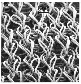
Abbildung 7 Wirkware aus Polyamid-6-Endlosfasern
