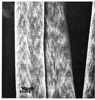
Abbildung 2 Polyacrylnitril-Fasern
