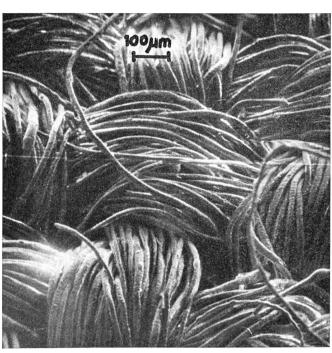
Abb. 13 Wollgewebe mit Filzfreiausrüstung (Sekundärelektronen-Bild)
