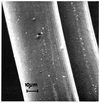
Abbildung 3 Polyamid-6-Fasern
