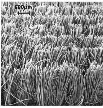
Abbildung 10 Polware aus Polyacrylnitril-Fasern
