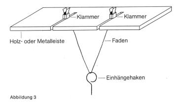
Jetzt werden beide Fadenklammern erfasst, der belastete Faden von der Leiste abgenommen und die Klammern so zusammengeführt, dass sich die frei durchhängende Fadenschlaufe zusammendrehen kann (Abb. 4).
