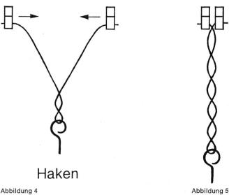
Drehungsergebnisse *nicht* mit 2 zu multiplizieren, wie dies bei Zwirnmessungen (Einspannlänge 50 cm) gemacht wird, um üblicherweise als Endresultat die Anzahl Touren pro Meter zu erhalten.
