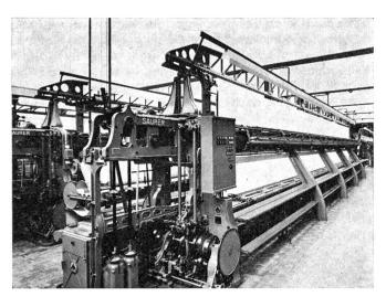
Stickereibetrieb mit SAURER-Automaten-Schiffchenstickmaschinen Typ 2S-55 mit automatischem Farb- und Rapportwechsel-Apparat
