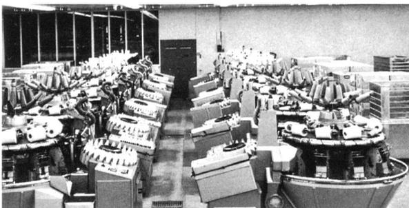
240 Spindeln des Schweizer Coners beanspruchen nur 274 Quadratmeter (Bedienungs- und Transportwege inbegriffen), für 7125 kg Qualitäts-spulen im 3-Schichtenbetrieb. Warum? Weil die CA 11-Automaten rund gebaut sind: 10 Spindeln (auf dem drehenden Rundtisch) und 1 Kontroll-stelle (mit dem stationären Knoter). Das bedeutet minimaler Platzbedarf für hohe Produktion.
