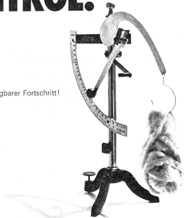
Genauigkeit und Konstanz der Kardenbandnummer sind nicht mehr von den Schwankungen des Wickelgewichts oder den Launen der Flockenspeisung abhängig. Hochleistungskarden, die mit der automatischen Kardenregulieranlage USTER CARD CONTROL ausgerüstet sind, produzieren ein Kardenband, das sich durch grosse Langzeitkonstanz der Nummer auszeichnet. Und zwar auch bei stark schwankendem Vorlagegewicht. Eine Reduktion der langwelligen Nummerschwankungen auf ca.  $\pm 2\%$  ist typisch.
