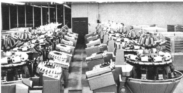
240 Spindeln des Schweizer Coners beanspruchen nur 274 Quadratmeter (Bedienungs- und Transportwege inbegriffen), für 7125 kg Qualitätsspulen im 3-Schichtenbetrieb. Warum? Weil die CA 11-Automaten rund gebaut sind: 10 Spindeln (auf dem drehenden Rundtisch) und 1 Kontrollstelle (mit dem stationären Knoter). Das bedeutet minimaler Platzbedarf für hohe Produktion.
