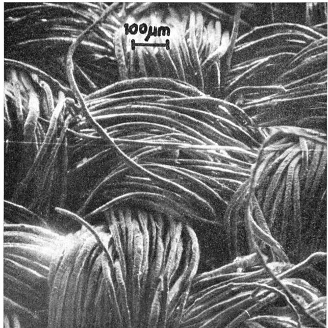
Abb. 13 Wollgewebe mit Filzfreieusrüstung (Sekundärelektronen-Bild)
