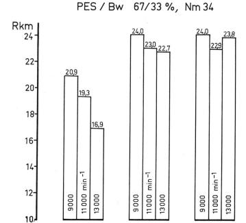
Abbildung 8 Abhängigkeit der Garnfestigkeit (RKm) von der Spindeldrehzahl beim Spinnen. Drei verschiedene Polyesterfasern, Baumwolltype, 1,7 dtex, 40 mm.
