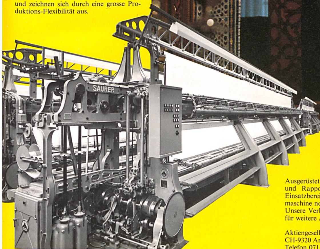
Ausgerüstet mit dem automatischen Farb- und Rapportwechsel-Apparat, wird der Einsatzbereich dieser Hochleistungs-Stickmaschine noch wesentlich erweitert.
