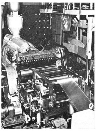
Abbildung 1 Laboranlage zur Kaltprägung von 90  $\mu$ -Film. Viele Weiterentwicklungen sind im Gange, die einen wesentlichen Einfluss auf die Produktionskosten von Fein-Denier-Fasern, hergestellt durch Rollenprägung haben können.
