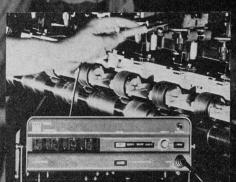
Durch serienmässig eingebaute Einzelmessonden und mittels Handstellenumschalter lassen sich die Spindeldrehzahlen
