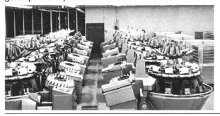
240 Spindeln des Schweiter Coners beanspruchen nur 274 Quadratmeter (Bedienungs- und Transportwege inbegriffen), für 7125 kg Qualitätsspulen im 3-Schichtenbetrieb. Warum? Weil die CA 11-Automaten rund gebaut sind: 10 Spindeln (auf dem drehenden Rundtisch) und 1 Kontrollstelle (mit dem stationären Knoter). Das bedeutet minimaler Platzbedarf für hohe Produktion.
