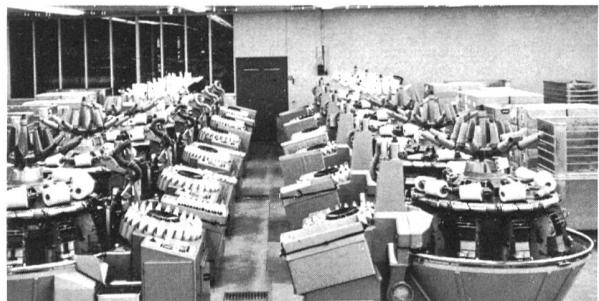
240 Spindeln des Schweiter Coners beanspruchen nur 274 Quadratmeter (Bedienungs- und Transportwege inbegriffen), für 7125 kg Qualitäts-spulen im 3-Schichtenbetrieb. Warum? Weil die CA 11-Automaten rund gebaut sind: 10 Spindeln (auf dem drehenden Rundtisch) und 1 Kontrollstelle (mit dem stationären Knoter). Das bedeutet minimaler Platzbedarf für hohe Produktion.
