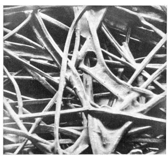
a) Wirrfaservlies, Spannungsfrei
