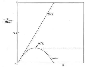
Abbildung 4 Modifikation der linearen Spannungs-Dehnungskurve unter Berücksichtigung des Gleitfaktors
