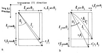
Abbildung 1 Deformation eines Faserelementes: a) gerade Faser,  $\mathsf{E_L}$ ,  $\mathsf{E_T}$  Positiv; b) gebogene Faser,  $\mathsf{E_T}$  negativ wie bei einachsigem Zug.
