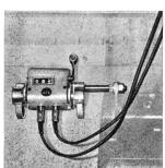
wickelt wurde, genügt sämtlichen Anforderungen in Bezug auf Messgenauigkeit, rationellen Einsatz und Preis. Das Gerät besteht aus einem Reihenzähler, ein oder mehreren Fadenlängenmessern und einem Stofflängenmesser und misst gleichzeitig sowohl die Fadeneinlauflängen mehrerer Bäume, wie auch die produzierte Stofflänge pro bestimmte Anzahl Maschenreihen.
