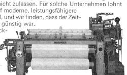
Einschützige SAURER-Automaten-Webmaschine Typ 100W
